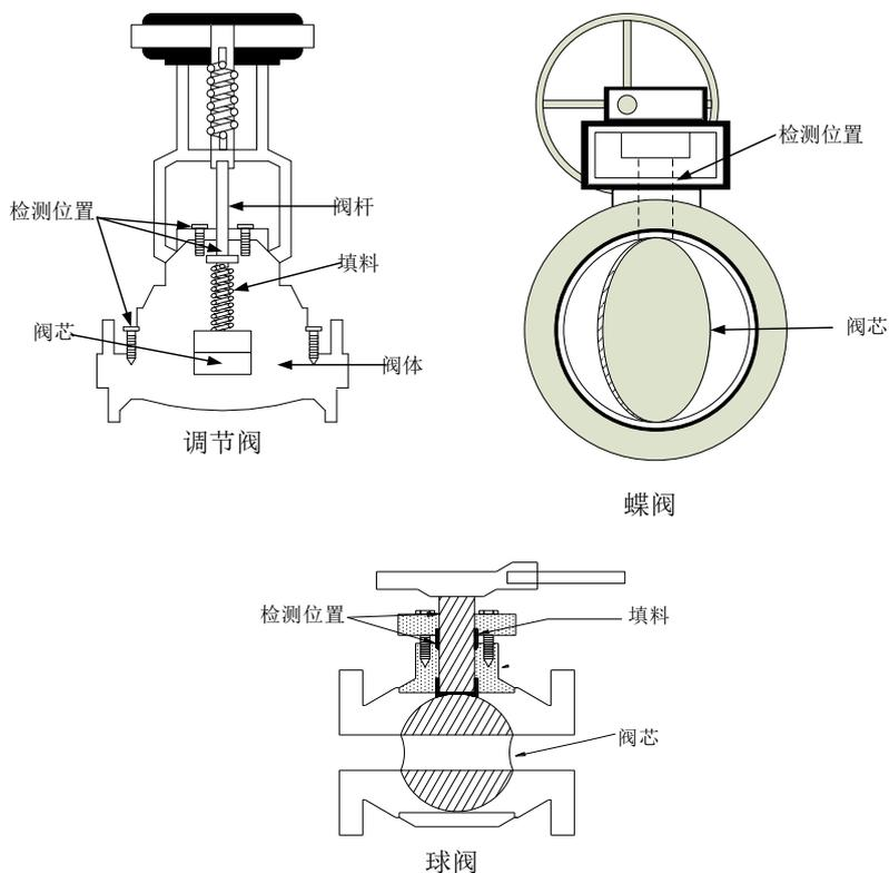
图 7 调节阀、球阀和蝶阀检测位置
