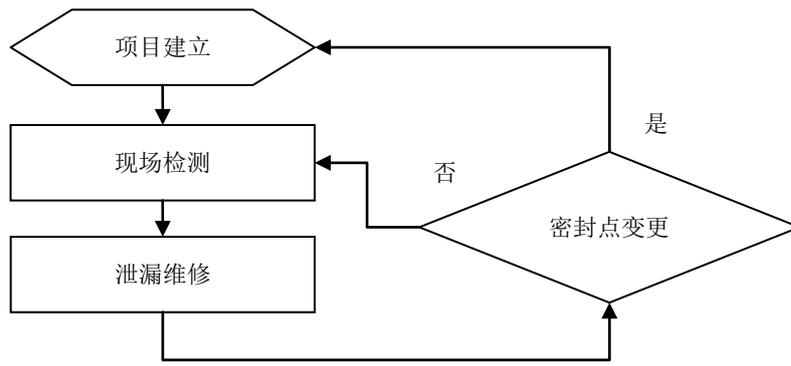
图 1 石化企业 LDAR 基本流程
