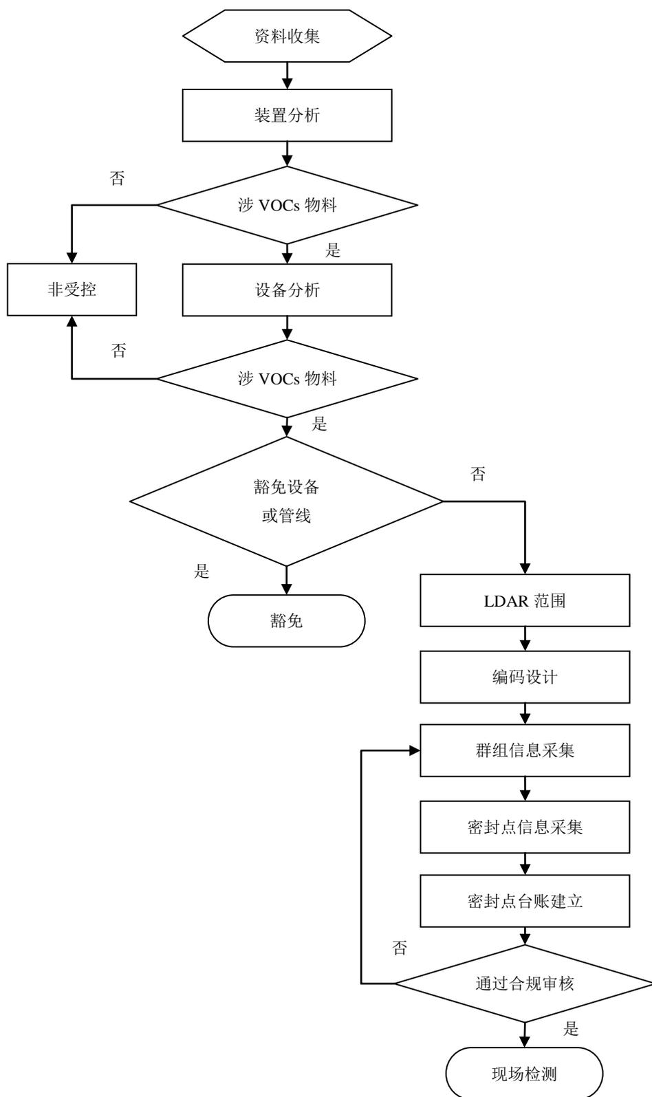
图 2 石化企业 LDAR 项目建立流程图
