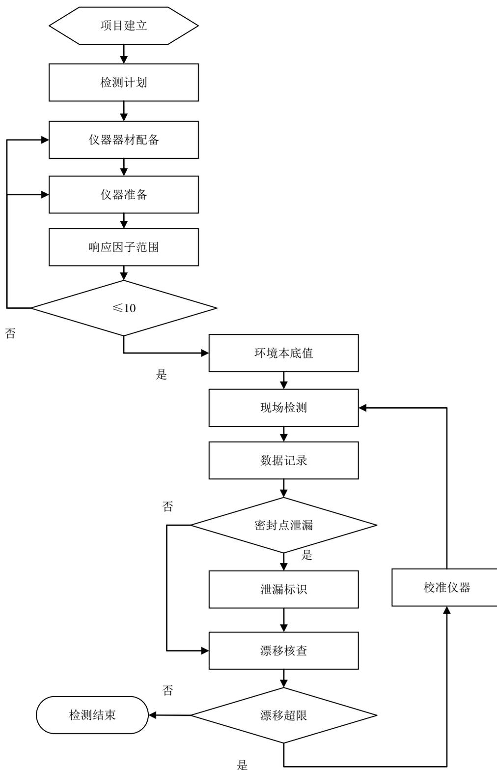
图 3 石化企业 LDAR 现场检测流程图
