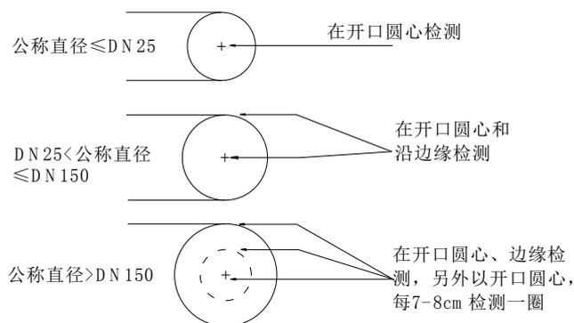
图 11 开口阀或开口管线检测
