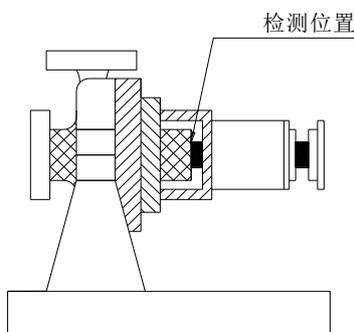
图 8 离心泵轴封检测位置
