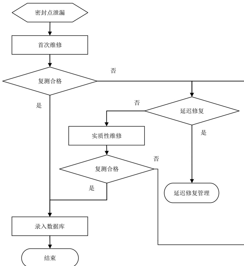
图 4 石化企业 LDAR 泄漏检测流程图
