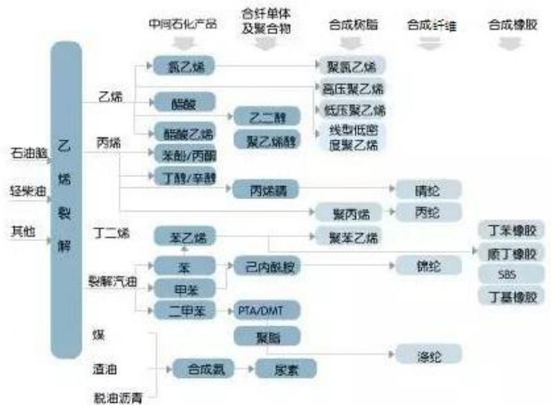
图 1 石油化工生产工艺流程简图
