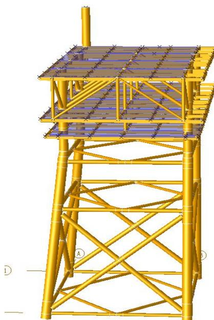
图 2.1-19 PAP 平台结构模型示意图
