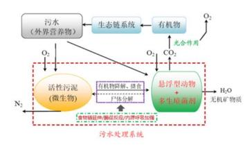
污泥原位减量技术原理图
