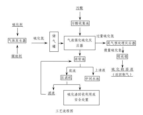
工艺流程为: 1、根据不同的工艺要求选择相应的硫化剂制备,控制硫化剂
