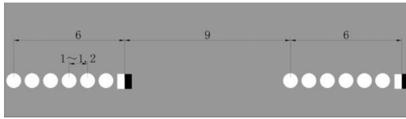
图 93 突起路标组成的虚线标线示例
