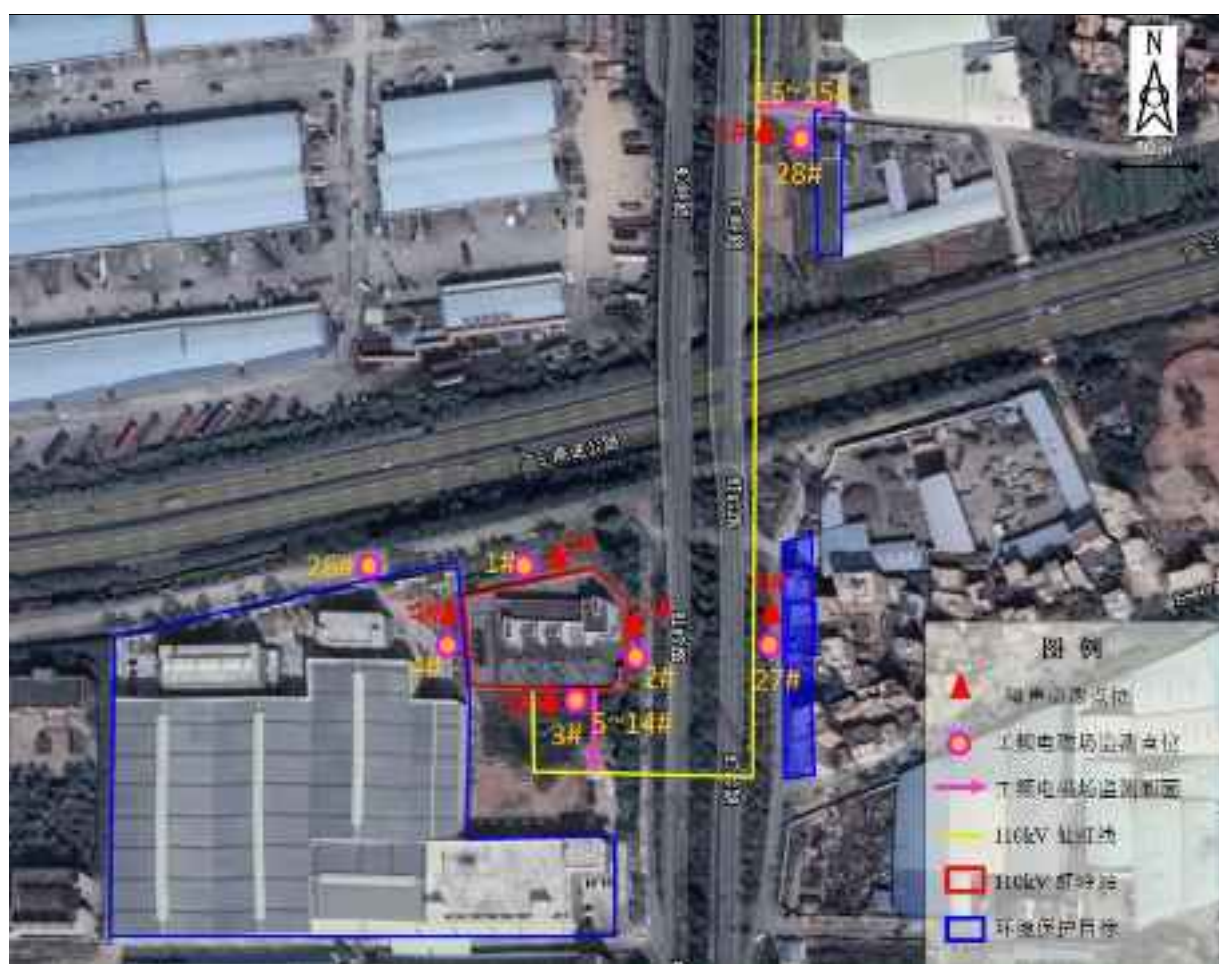
图 6-5 110kV 虹岭变电站厂界及断面监测布点图
