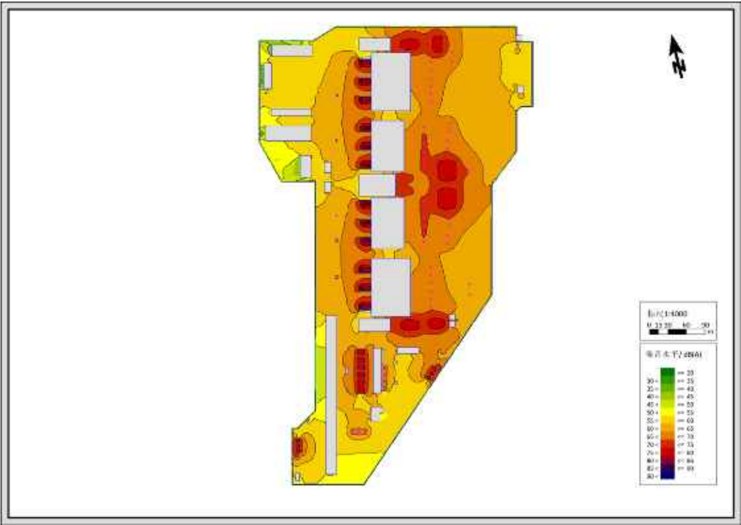
图 6-70 察隅换流站本期噪声贡献值等声级曲线预测图（1.2m 高）
