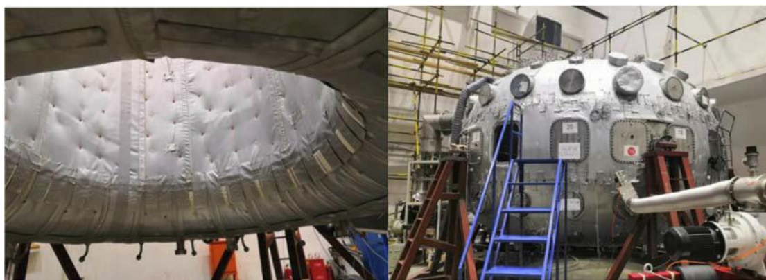
图 3.2-4 真空室保温层结构
