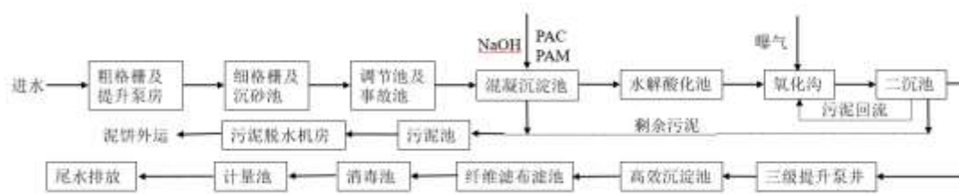
图 6-83 瑞金工业污水处理厂污水处理工艺示意图
