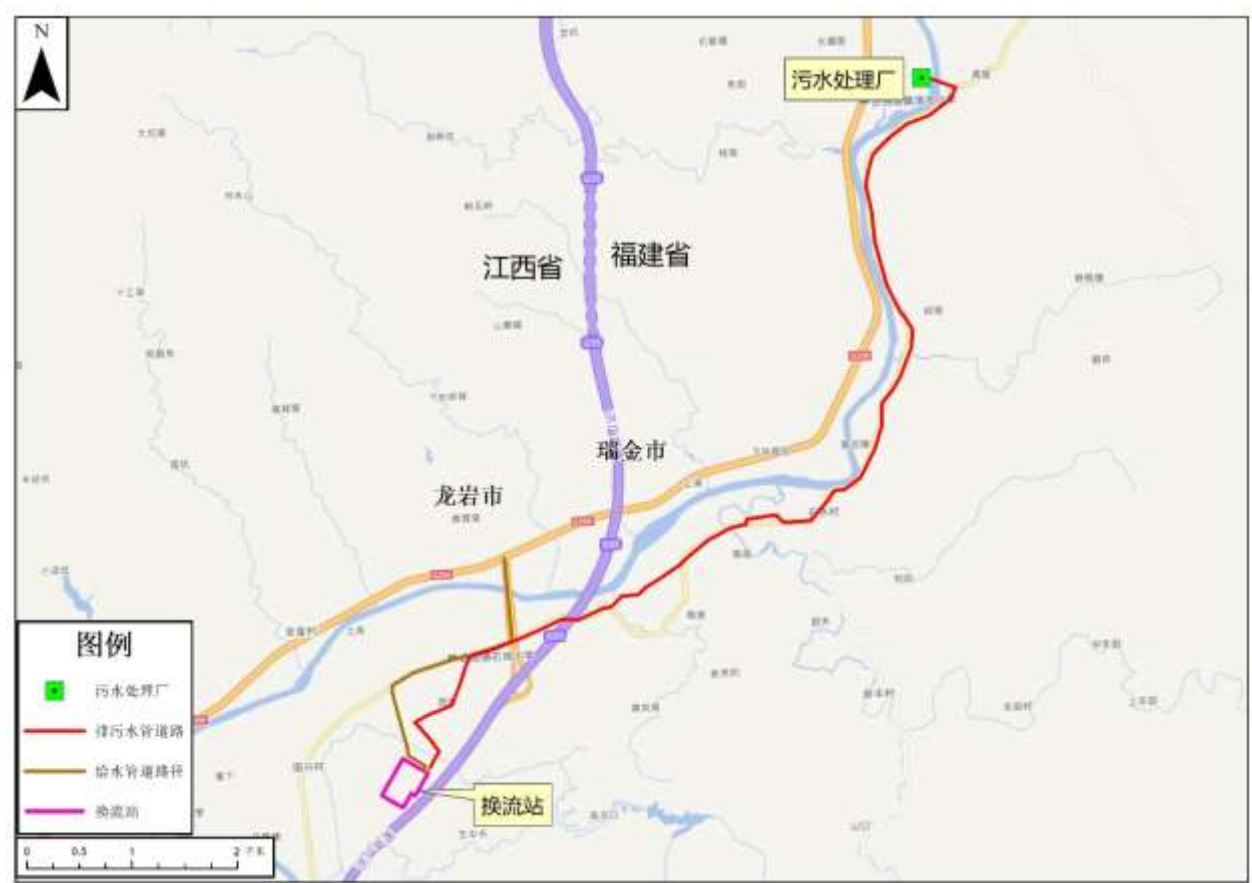
图 3-3 换流站供排水管道示意图
