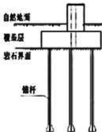
图 3-11 岩石锚杆基础示意图
