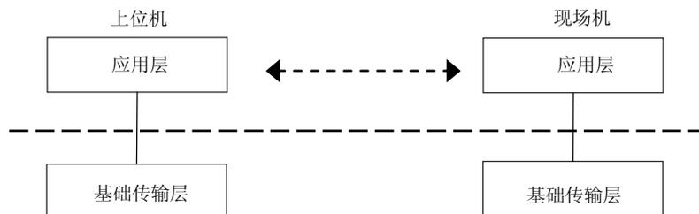
图 3 数据传输通信协议结构示意图
