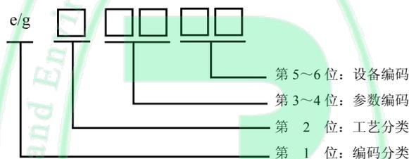
图 5 污染物排放过程（工况）监控参数编码规则示意图
