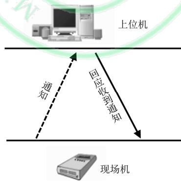
图11 现场机通知上位机命令流程示意图
