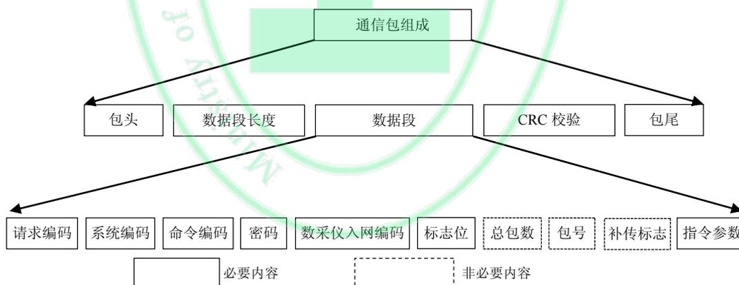
图 4 通信协议数据结构示意图
