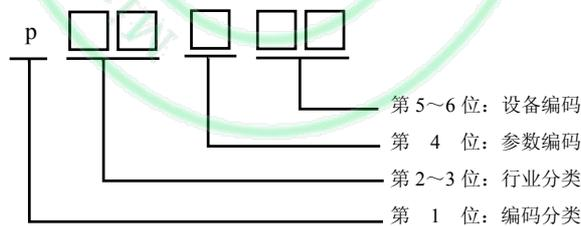
图 8 关键生产工况参数编码规则示意图
