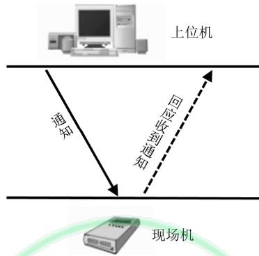
图 12 上位机通知现场机命令流程示意图
