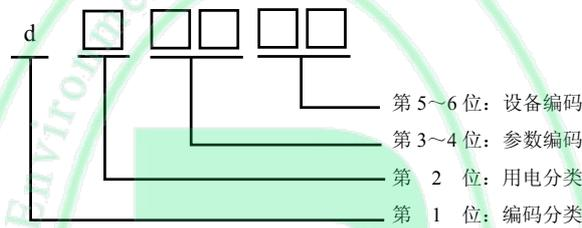
图 7 用电参数编码规则示意图
