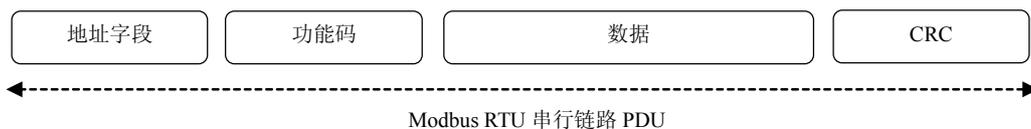
图 14 串行链路上的 Modbus 帧示意图
