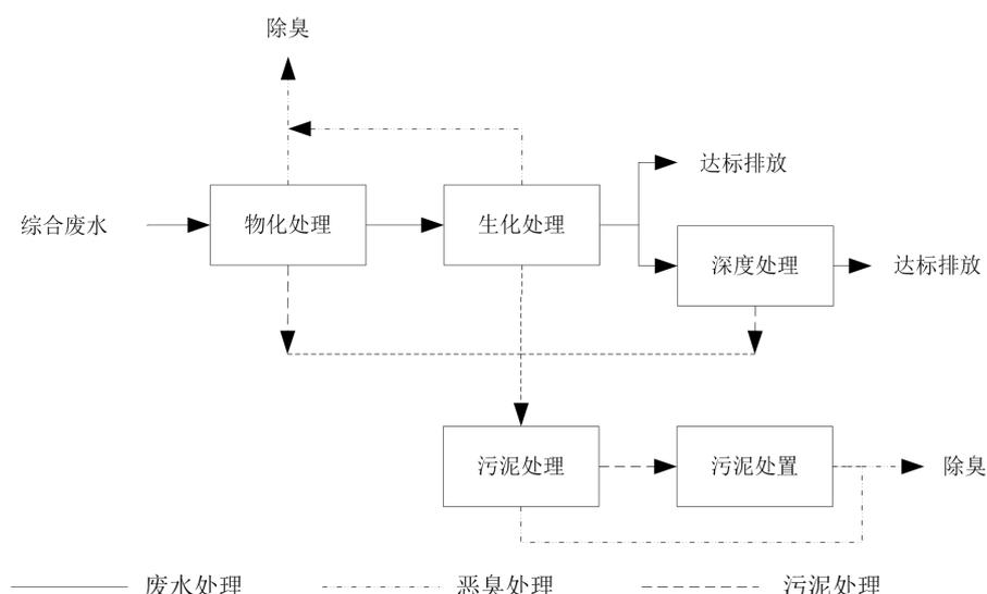
图 1 石油炼制工业废水治理工艺流程图
