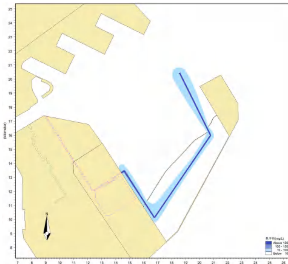
图 6.1- 21 施工悬浮物最大可能影响范围（取水水道和取水口）
