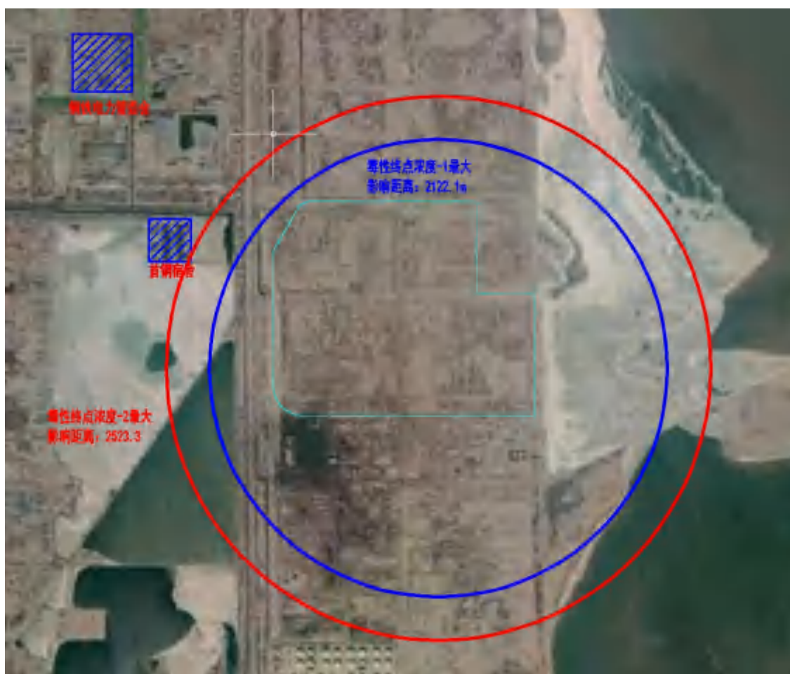
图 7.5- 2 硫磺回收装置硫化氢泄漏扩散影响范围图
