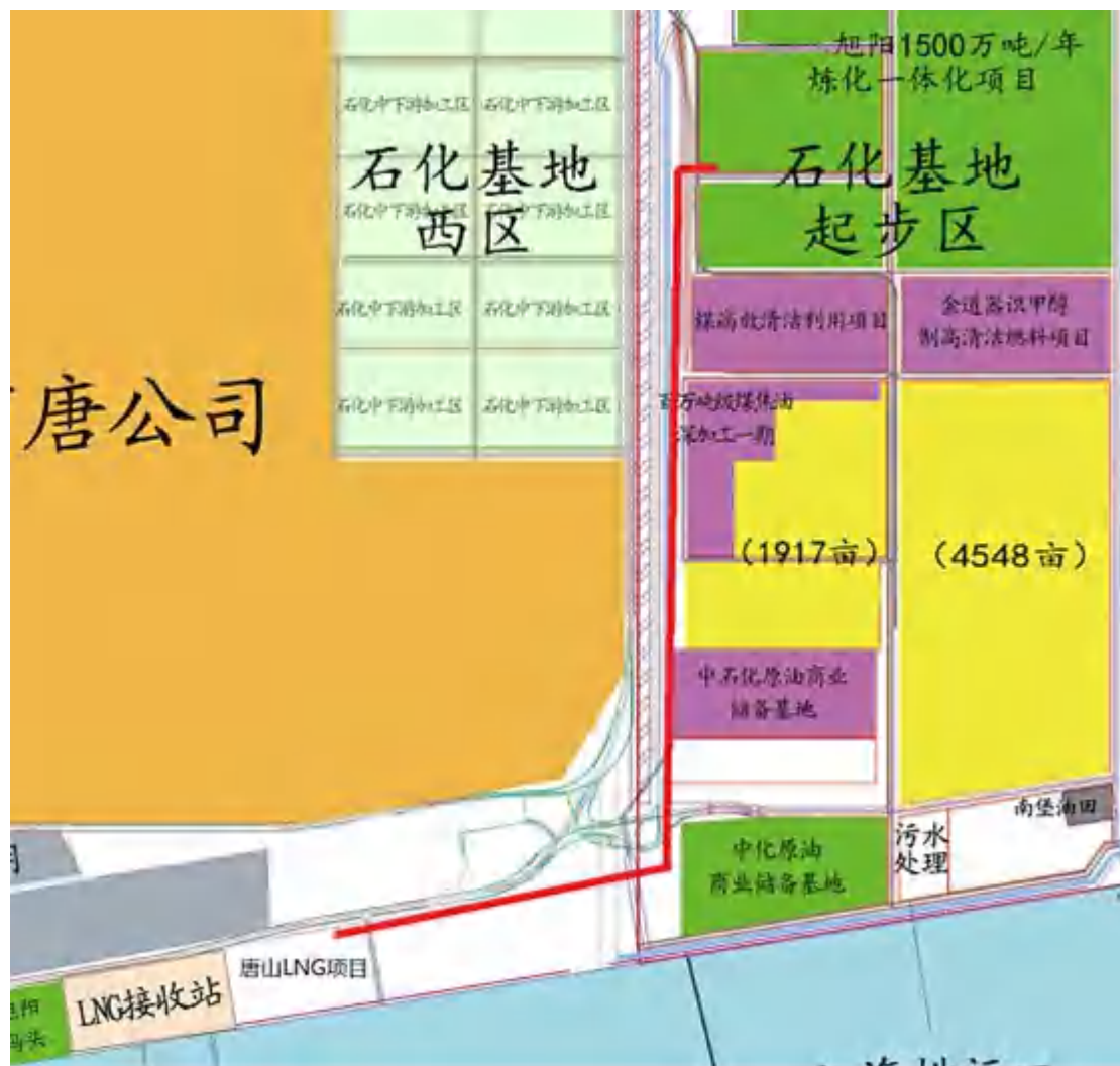
图 9.3-1 唐山 LNG 项目至旭阳炼化一体化项目温排水/热水管道示意
