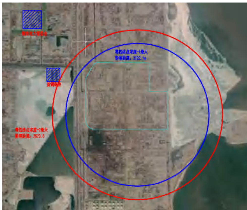
(a) 硫磺回收装置硫化氢泄漏扩散影响范围图
