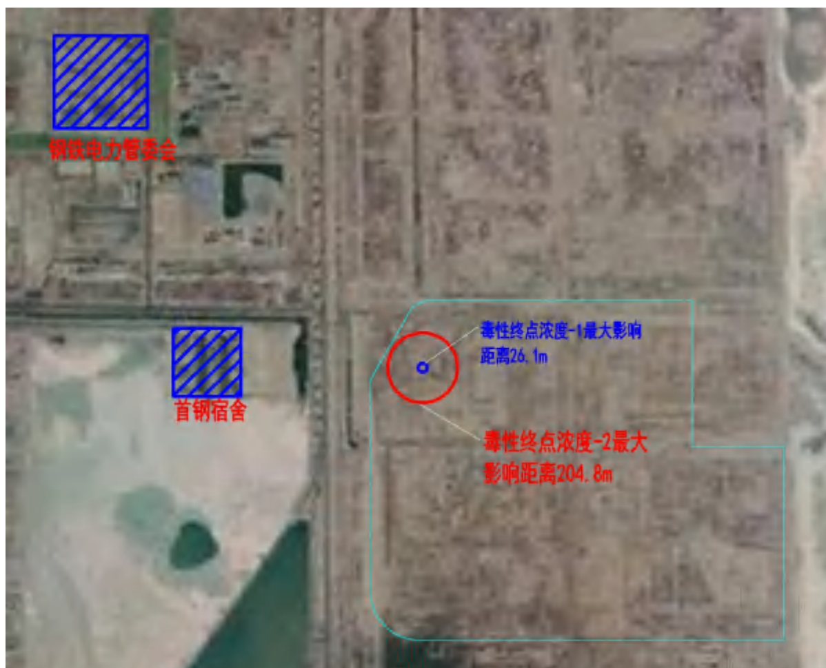
图 7.5- 5 对二甲苯储罐对二甲苯泄漏扩散影响范围图
