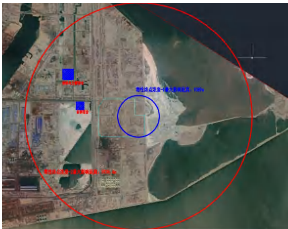
图 7.5- 3 液氨储罐液氨泄漏扩散影响范围图
