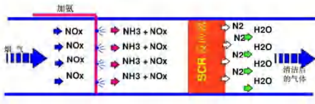
图 8.2-1 SCR 脱硝原理图
