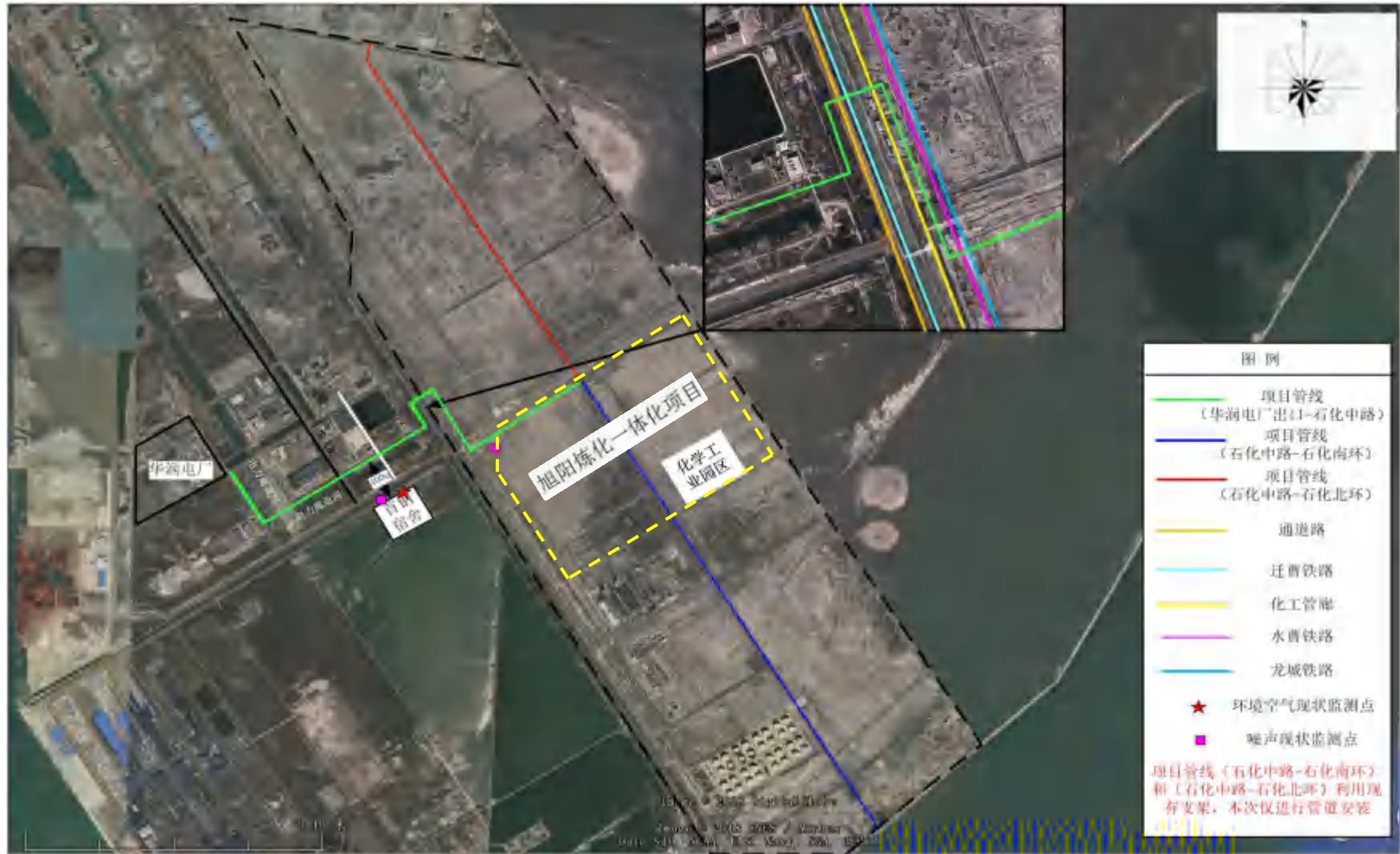
图 3.6- 1 供热 (蒸汽) 管线图
