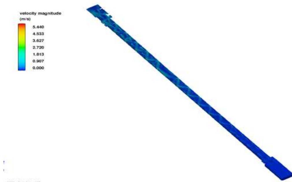
图 8.4-9 鱼道进口三维流速图
