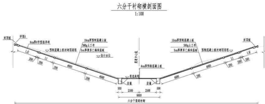
图 2.8.4-1 六分干衬砌断面示意图
