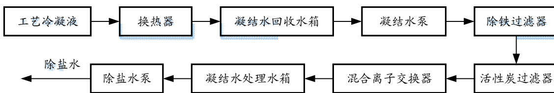
图 4.4-3 工艺凝结水制除盐水流程图
