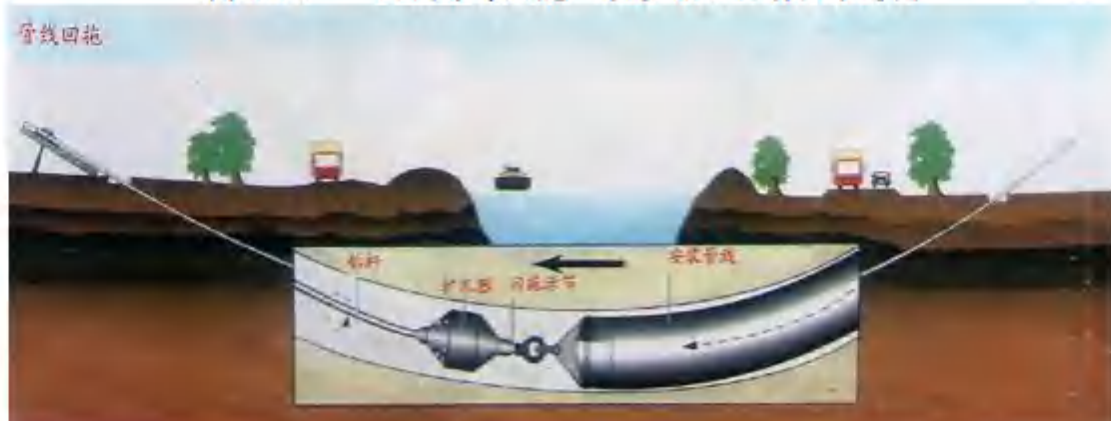
图 4.1-8 定向钻穿越施工预扩孔过程断面示意图
