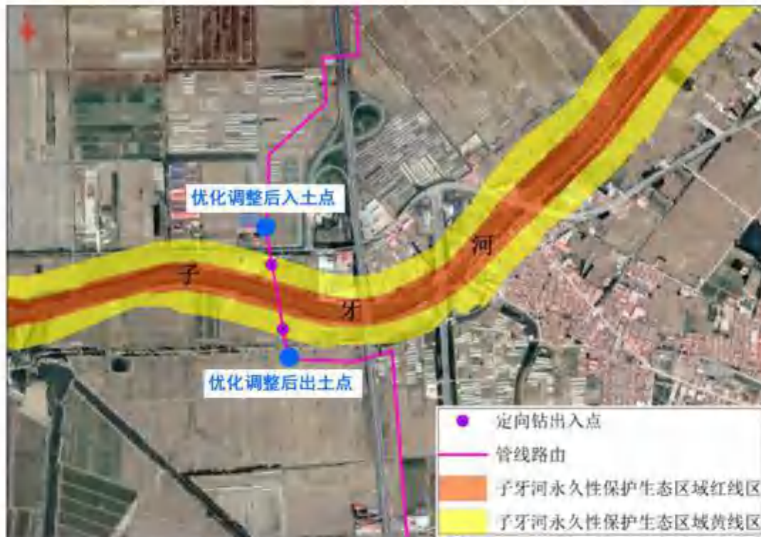
图 15.3-34 子牙河定向钻工程优化调整图
