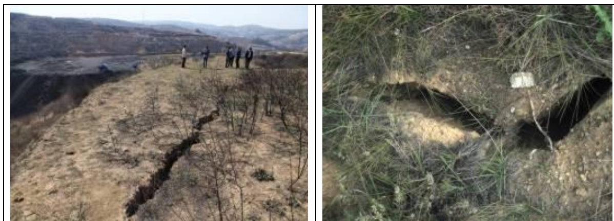
图 5.2-2 沉陷区裂缝图
