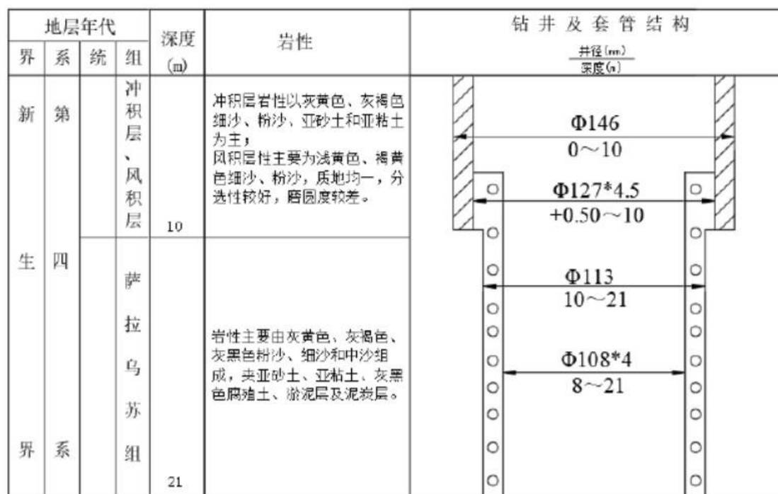
图 5.6-4 监测孔井身结构图
