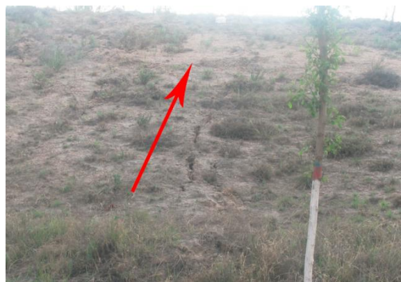
金凤煤矿采空区上方裂缝
