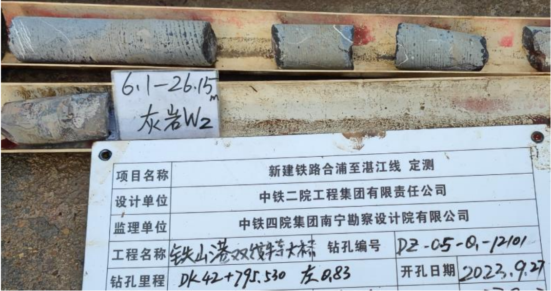
图 3.3.6-18 铁山港特大桥地质钻孔灰岩取芯照片
